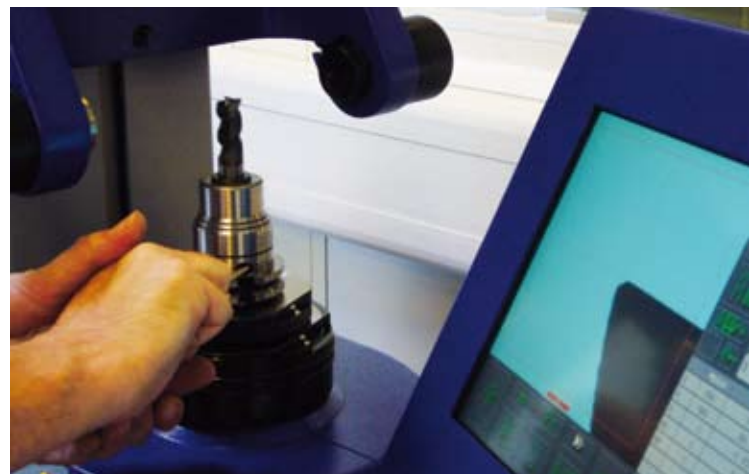
4. Schritt: Spannfutter wieder spannen, diesmal „exakt“ bis zum vorgegebenen Sollwert schließen. Ein Anzugsmoment von min. 10 bis max. 14 Nm ist zum sicheren Spannen des Werkzeuges ausreichend. Step 4: Close the chuck again at the exact given set point. A clamping torque of min. 10 to max. 14 Nm is enough for the safe clamping of the tool.
