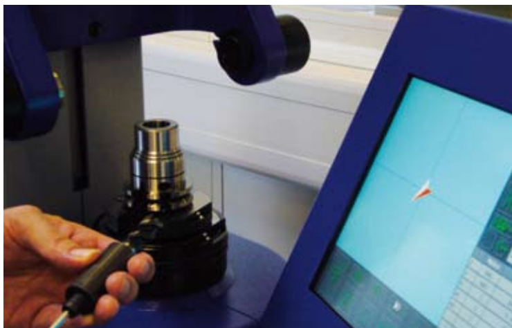
3. Schritt: wieder Öffnen und durch Drehen des Längenanschlages eine „grobe“ Längenkorrektur vornehmen. Eine Umdrehung am Längenanschlag entspricht 1 mm Längenkorrektur. Step 3: Open again and turn the length stop for a rough length correction. One turn of the screw corresponds to 1 mm length correction.
