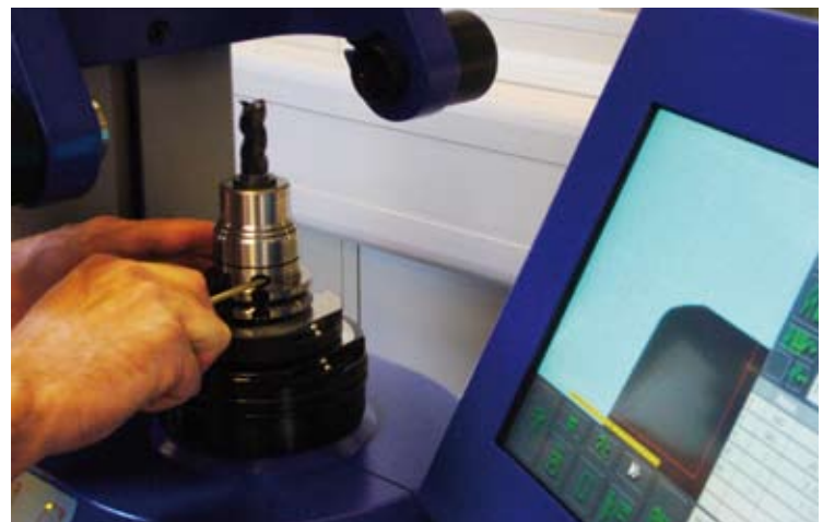
2. Schritt: Spannen des Futter, dabei optisch die Soll-Ist-Abweichung feststellen Step 2: Clamping of the chuck with optical check of deviations in set-actual values.
